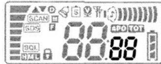
2. Halten Sie die **CH** und **SET** Tasten gleichzeitig gedrückt. Lassen Sie die Taste **SET** los (halten Sie dabei die **CH** Taste weiter gedrückt). Drücken Sie nun wiederholt entweder die **UP** oder **DOWN** Tasten bis die Anzeigen **M** oder **SOS** im Display erscheinen. (**M** zeigt den Speicherkanal und **SOS** zeigt den Notrufkanal).
