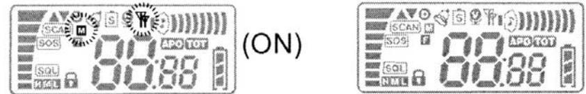
Um diese Funktion zu aktivieren halten Sie die PTT Taste gedrückt und drücken gleichzeitig kurz auf die **CH** Taste. Das Antennen-Symbol
