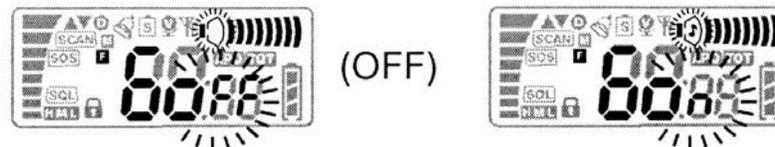
**F 7.** Automatische Abschaltung (APO): Unter Menüpunkt 7 können Sie wählen zwischen einer automatischen Abschaltung des Geräts nach 03 / 10 / 30 / 60 Minuten oder der Einstellung „OFF“. In der Einstellung 03 zum Beispiel schaltet sich das Gerät von selbst aus wenn 3 Minuten kein Signal empfangen wurde und keine Taste am Gerät gedrückt wurde. 30 Sekunden bevor sich das Gerät ausschaltet hören Sie zwei Warntöne.
