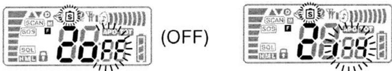
**F 3.** Unter Menüpunkt 3 können Sie die VOX Funktion (Sprachsteuerung) ein- / ausschalten. Ab Werk ist die VOX Funktion ausgeschaltet.
