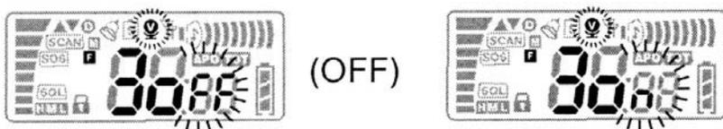
**F 4.** Unter Menüpunkt 4 können Sie zwischen 8 VOX Empfindlichkeitsstufen wählen. L8 steht hierbei für die geringste Empfindlichkeit. Wenn die VOX Funktion unter Menüpunkt 3 deaktiviert wurde ist diese Funktion gleichzeitig auch deaktiviert. Das Gerät geht in diesem Fall direkt zu Menüpunkt 5 über.
