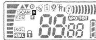
1. Halten Sie die **CH** Taste gedrückt und drücken Sie kurz die **DOWN** Taste um den Speicherkanal aufzurufen. Der Speicherkanal wird durch ein **M** im Display gekennzeichnet (siehe auch Rubrik 18)
