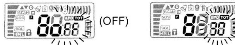
**F 9.** Menüpunkt 9: Squelch-Einstellung. Ab Werk ist das Gerät auf Stufe L3 eingestellt. Wenn Sie die Stufe 0 wählen ist das Hintergrundrauschen permanent zu hören. Bei Stufe L1 können Sie auch schwache Signale noch empfangen, ebenso wie Interferenzen. Bei starken Interferenzen sollten Sie die Stufe L9 wählen.
