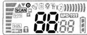
Drücken Sie kurz die **CH** Taste. Die Kanalnummer blinkt nun im Display. Drücken Sie anschließend gleichzeitig die **UP** / **DOWN** Tasten um die Dual Watch Funktion zu aktivieren. Drücken Sie kurz die **CH** Taste um die Dual Watch Funktion zu unterbrechen. Sollte auf einem der beiden überwachten Kanäle ein Signal empfangen werden können Sie direkt antworten.
